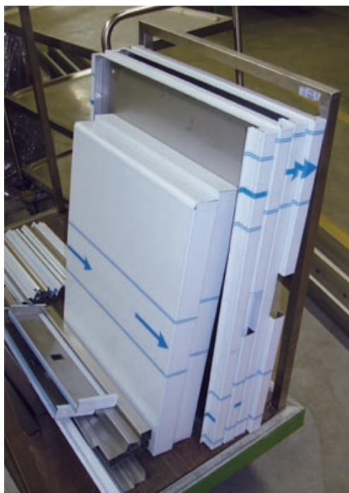
Arkusze blachy należy przechowywać pionowo, a ochronną warstwę tworzywa należy zostawić na stali możliwie jak najdłużej podczas jej przeróbki.
