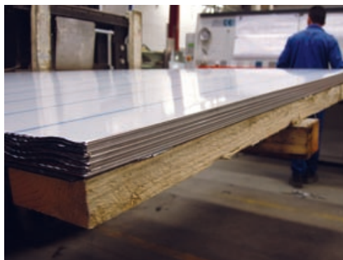
Arkusze blachy stali odpornej na korozję mogą być dostarczane z pokryciem ochronnym z tworzywa sztucznego.
