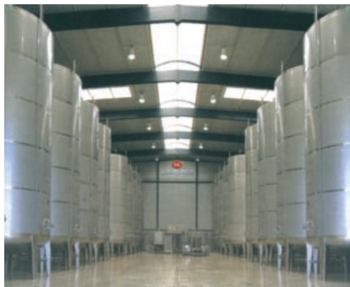
Powierzchnia stali odpornej na korozję jest jasna i atrakcyjna estetycznie, i przede wszystkim łatwa w czyszczeniu i konserwacji. Zdjęcie: Cedinox
